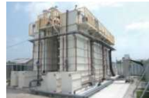
节能型MBR (膜分离活性污泥) 中试装置
