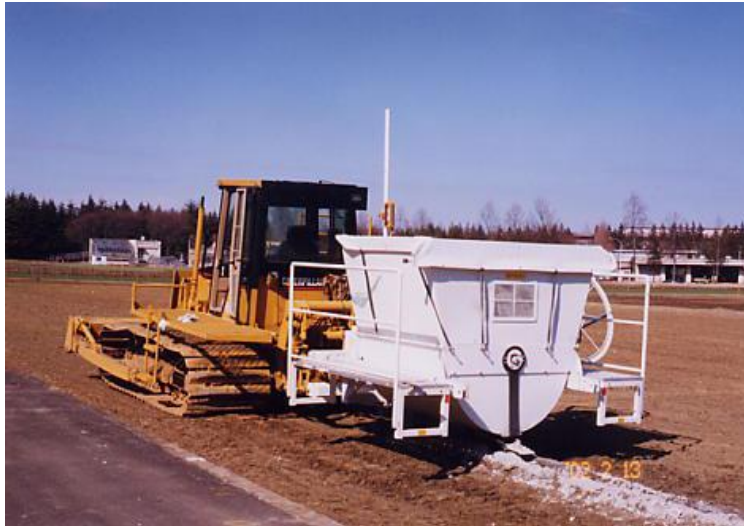
無掘削暗渠施工装置(スガノ農機)
