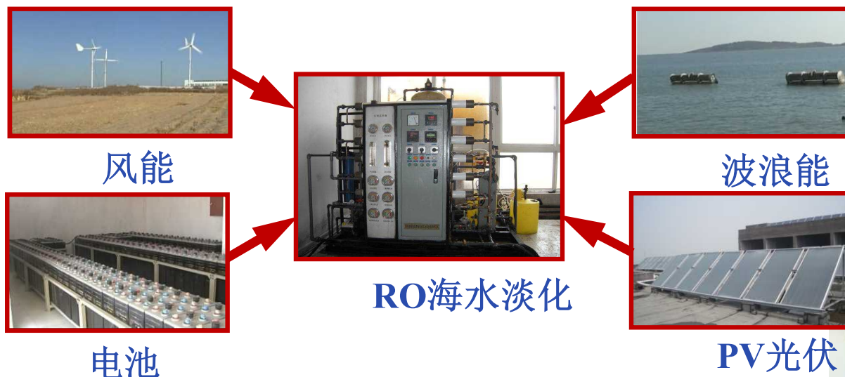
大管岛5m 3 /d 多元耦合供能反渗透海水淡化装置
