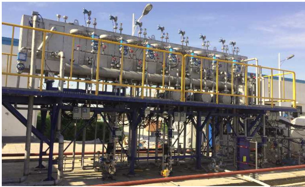
新疆托甫基地の太陽エネルギー 光熱+ガス発電機排気ガス余熱カ ップリング供給多効板式蒸留淡 水化装置、24トン/日
