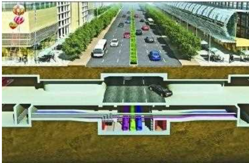
综合管廊效果图 総合管廊の効果図
