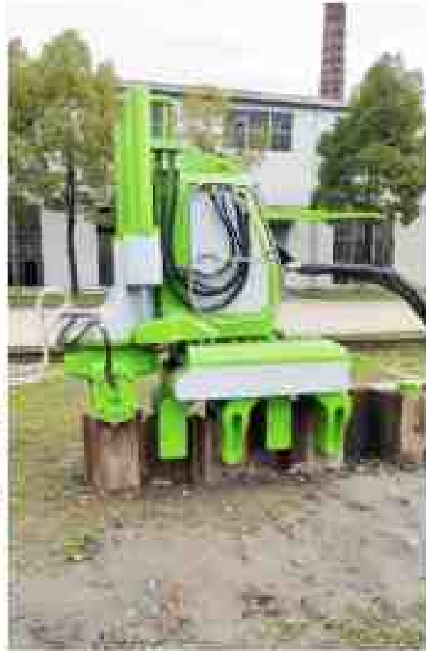
静圧植付機 静圧杭打ち機
