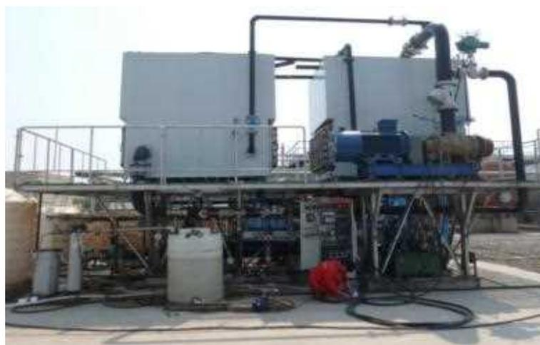
中海油渤西油气处理厂60吨/日采油废水机械压缩蒸馏装置 山东招金24吨/日金银冶炼废水机械压缩蒸馏零排放工程
