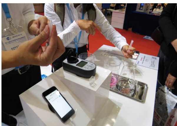
「WATER it」の試薬～分析器～スマホ（ポータル）
