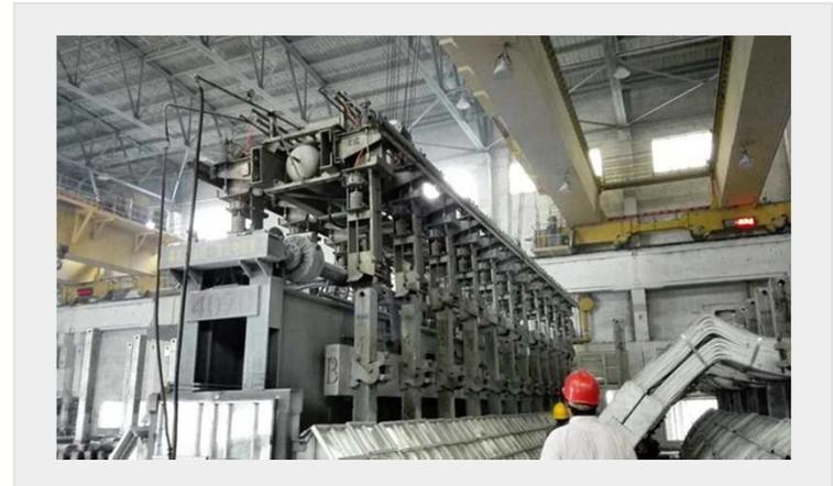
**改良内容:**バス・フレームごとにガス増圧機を仕掛けて、圧力を5barから6.5barまで上げる。
