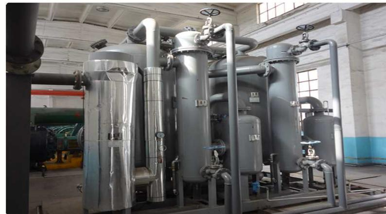
改良内容: ガス処理能力 $200\text{m}^3/\text{min}$ の圧縮熱再生乾燥機1台でガス処理能力 $100\text{m}^3/\text{min}$ のマイクロ熱乾燥機2台を切り替える。
